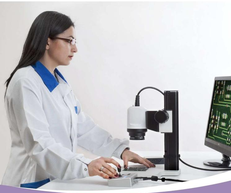
Vielseitiges, skalierbares und preiswertes Video-Inspektions-System zur schnellen und verlässlichen Optischen Inspektion. Die W20x ist mit einem leistungsfähigen 20x Zoom ausgestattet, ermöglicht einen großzügigen Betrachtungsabstand und arbeitet mit einem schnellen Autofokus für eine klare Darstellung Ihrer Objekte in echter High Definition Qualität.
