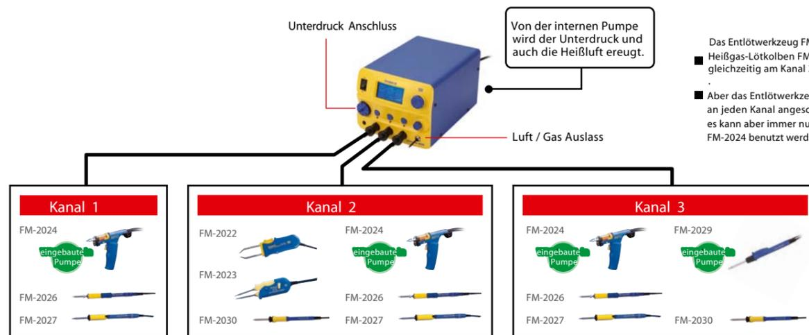
Das Entlötzwerkzeug FM-2024 und der Heißgas-Löt kolben FM-2029 können nicht gleichzeitig am Kanal 3 betrieben werden.
