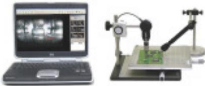
Tauschen Sie die BGA-Linse durch eine beigefügte Standard-Zoom Linse aus und konvertieren Sie die Flexia Kamera in ein hochauflösendes Videomikroskop zur Inspektion von bestückten Leiterplatten, Lötstellen, Komponenten....
