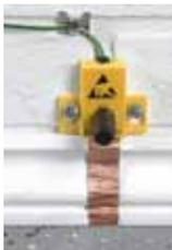
Erdungsanschluss-Set für Bodenbeläge zur Wandmontage, mit Testpunkt (4 mm Buchse) und 2 m selbstklebendem Kupferband, zum Erden einer Fläche bis 10 x 20 m. Erdungsleitung 3 m mit Öse.
