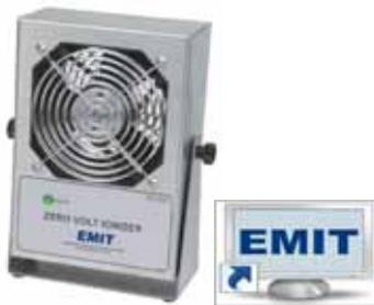
Tisch-Ionisiergerät, 24,1 cm (H) x 15,2 cm (B) x 7,9 cm (T). Hochwertige Edelstahlausführung. Mit Schnittstelle für EMIT-Überwachungssoftware. Niedrige Offset-Spannung ( $< \pm 50$ V), Rückmeldesignal. Zweistufiges Gebläse. Gleichbleibend stabile Ionisation, Selbstbalancierung der Offset-Spannung  $\pm 5$  bis  $\pm 20$  V.
