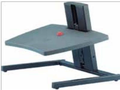
Ein stabiler Stahlrahmen trägt diese komfortable Fußstütze. Durch eine eingebaute Gasfeder läßt sich diese Fußstütze durch einfache Fußbedienung stufenlos von 20 mm bis 280 mm verstellen.
