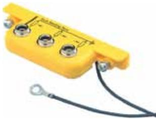
Erdungsbox mit 3 Anschlüssen seitlich montiert, flache Bauart (Tiefe 17 mm) als zentraler Erdungsanschlusspunkt, Erdungsleitung 2 m mit Schrauböse M4 / Anschlussstecker, 1 MOhm Sicherheitswiderstand je DK = Druckknopf.
