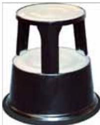
Trotz seines geringen Eigengewichts steht dieser Rollhocker durch seine auf Stahlfedern gelagerten Rollen und seinem dicken Gummiring ab einer Belastung von 5 kg unverrückbar fest.
