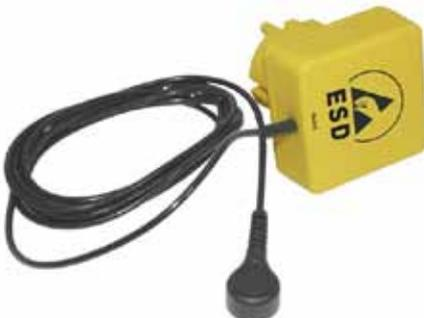
Erdungsbaustein 1 Anschluss, glattes Kabel 1,5 m lang, Anschlussstecker mit Kunststoff-Haltestiften, 1 MOhm Sicherheitswiderstand
