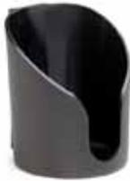
Ein praktischer Flaschenhalter für Arbeitstische. Er paßt für Ø 80 mm Flasche oder Becher. Halter kann leicht ans Aluminiumprofil geschraubt werden. Aus schwarzem Polypropylen. Passend für: AL2X-, WTR-Profile.
