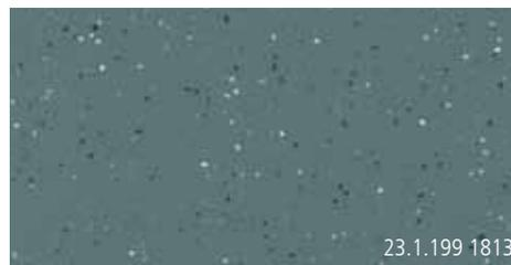
Synthetikgummi, **einschichtig**, elektr. leitfähig
