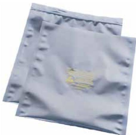
Metallisierte, transparente (40% Lichtdurchlass) Abschirmbeutel Typ „metal out“, abriebfeste Beschichtung, Aluminiumbedampfung, ableitfähiges Polyester, ableitfähiges Polyethylen, Seitenschweißnaht, verschweißbar oder wiederverschließbar mit Zipper.
