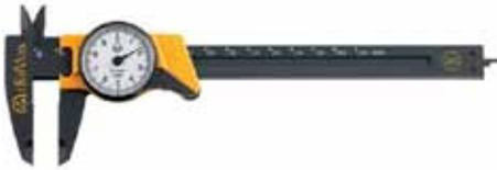
Ablesung 0,1 mm, aus elektrostatisch ableitendem Material, stoßgesicherte Uhr, Rundskala auf Null justierbar, Vergleichsmessungen möglich. Außen-, Innen-, Tiefen- und Stufenmessungen, für alle Arbeiten an elektrostatisch gefährdeten Bauteilen.
