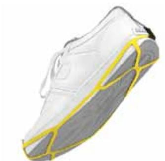
Flexibles, dehnbare Fußsohlennetz, passend für sämtliche Schuhgrößen, Kontaktpunkte an Sohle und Absatzbereich, Neopren-Gummi ohne Kohlenstoff, hinterlässt keine Abfärbungen am Schuh oder am Fußboden, 1 Megaohm Vorwiderstand.
