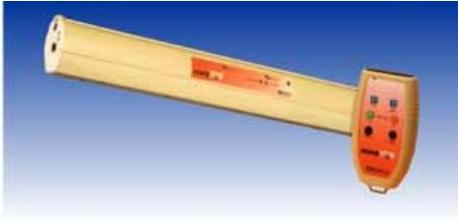
Das Modell ScorplON™ mit seiner aerodynamischen Form ist speziell geeignet für den Einsatz im Laminairluftstrom. Die Justierung der Ionenbalance kann bequem über die Fernbedienung durchgeführt werden. Reinraumtauglich (Klasse 1)
