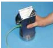
Das ESD-Protect FLOOR Prüfgerät dient dem schnellen, normkonformen Überprüfen von ableitfähigen Boden- und Tischbelägen, Stühlen und Rollwagen. Auch Systemprüfungen (Schuhe-Boden) können auf einfachste Weise durchgeführt werden. Der verstellbare Nylontragriemen erlaubt ein normales, ermüdungsfreies Arbeiten im Stehen (ohne dauerndes Bücken).
