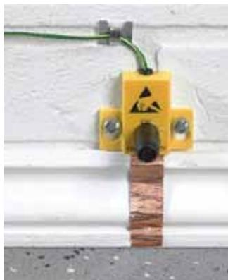
Erdungsanschluss-Set für Bodenbeläge zur Wandmontage, mit Testpunkt (4 mm Buchse) und 2 m selbstklebendem Kupferband, zum Erden einer Fläche bis 10 x 20 m. Erdungsleitung 3 m mit Öse.
