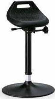
Gasfeder-Höhenverstellung von 650 bis 850 mm. Um 360° drehbare Sitzfläche aus leitfähigem Integralschaum. Tragegriff. Flacher, leitfähig beschichteter Tellerfuß. Sitzneigeverstellung um 10° nach vorne.
