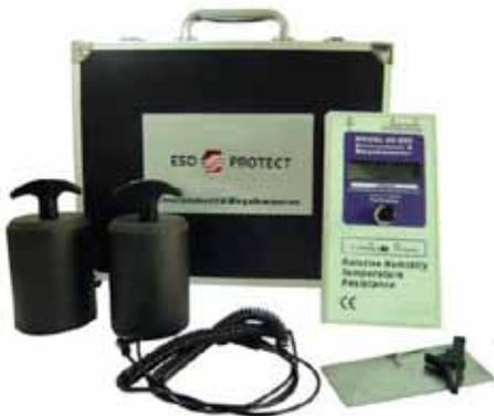
Messelektroden-Set zur Messung des Oberflächenwiderstands, der Temperatur und rel. Luftfeuchte. Kofferset mit Messgerät, 2 Elektroden, Metallplatte (142x67mm).
